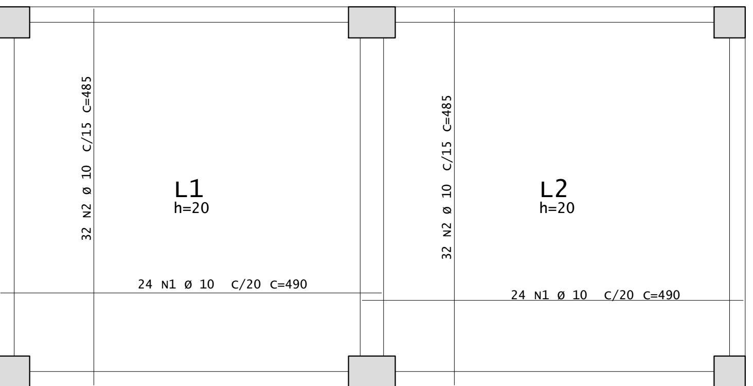
ARMAÇÃO POSITIVA DAS LAJES NÍVEL +41,37 ESCALA - 1:50
